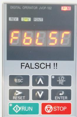
Nach dem Einschalten wird bei richtiger Einstellung und Anschluss der Anlagendruck angezeigt..
